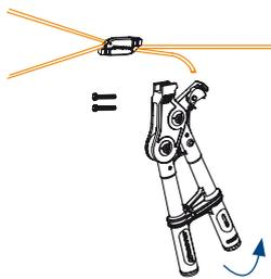
Etape 1 : Tournez la molette sur le niveau de tension souhaitée (jusqu'à 100 kg maximum).
