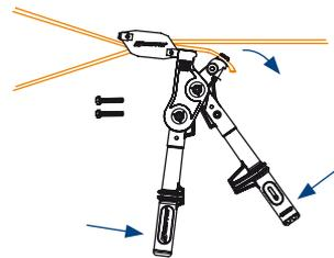
Etape 3 : Resserrez les poignées ensemble pour appliquer la tension au câble, répétez l'action si besoin jusqu'au bruit de « dé clic » au niveau des poignées.
