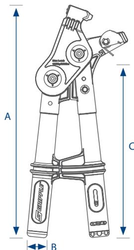
Attention : appliquer une tension trop importante peut endommager la structure interne du câble et du galet Gripple ou provoquer l'arrachement des ancrages.
