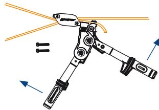
Etape 2 : Placez la mâchoire de l'outil contre le galet Gripple, écartez complètement les poignées et agrippez l'extrémité du câble avec la came.
